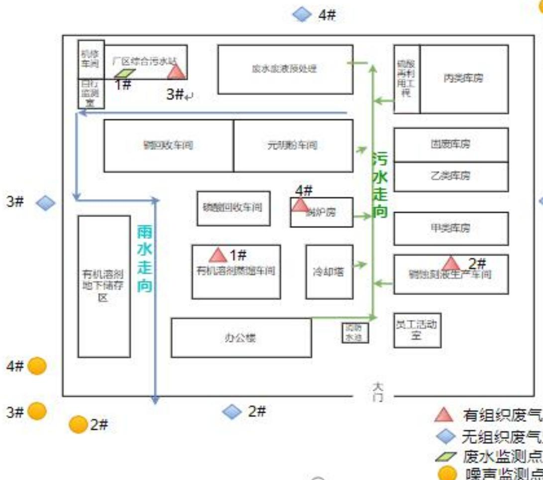
雨水收集系统图及水综合利用图
